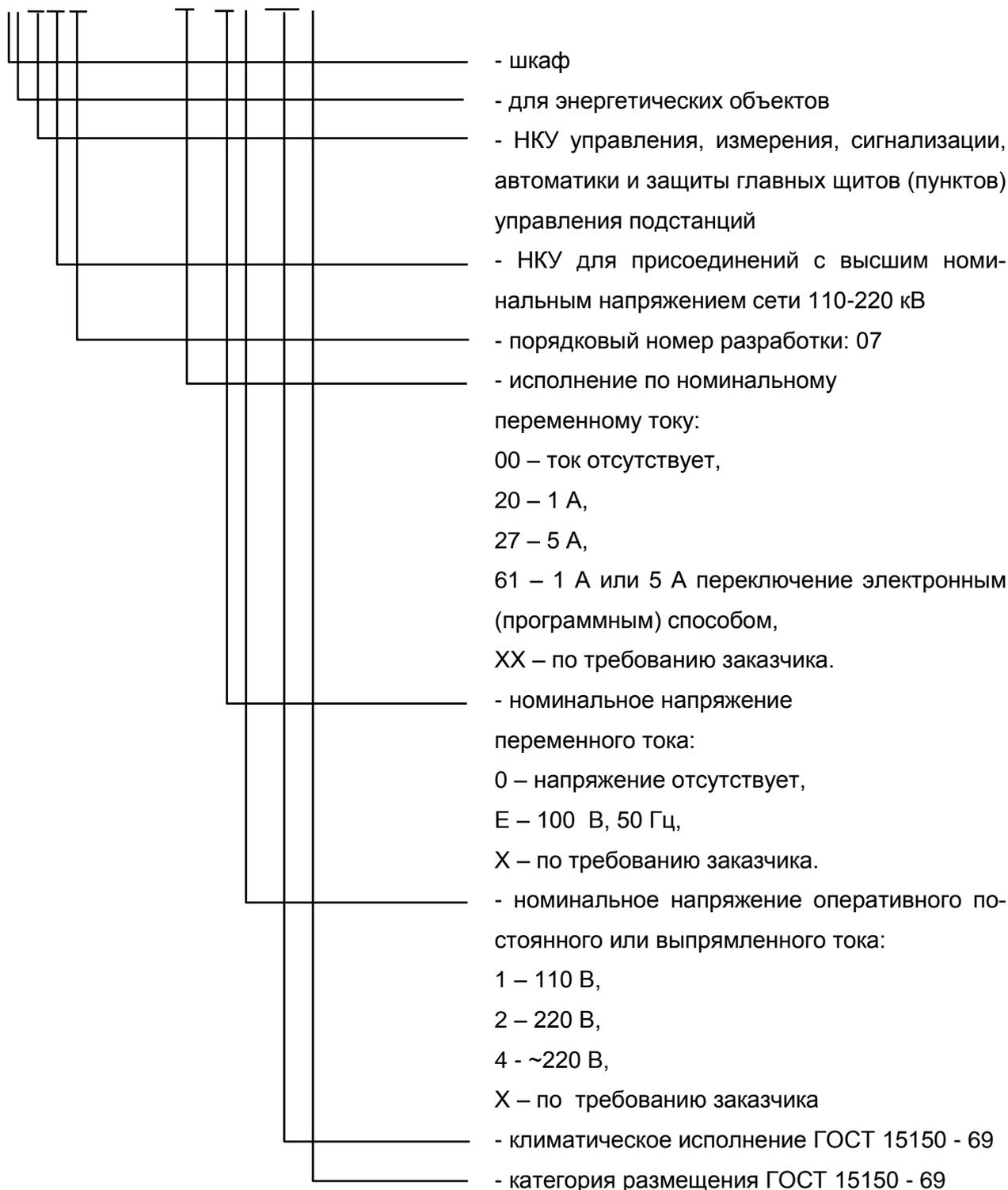
Пример записи обозначения шкафа ШЭ2607 215 на номинальный переменный ток 1А или 5 А, номинальное напряжение переменного тока 100 В частотой 50 Гц и номинальное напряжение оперативного постоянного тока 220 В при его заказе и в документации другого изделия для поставок в Российскую Федерацию:
